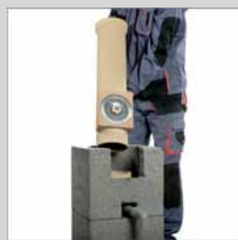
4. Nałożyć kit kwasoodporny na oczyszczony wilgotną gąbką kielich miski kondensatu. Wkleić wyczystkę
