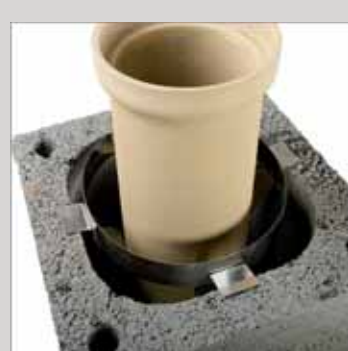
13. Osunąć opaskę dystansową do górnej powierzchni pustaka tak, aby oparły się zewnętrzne elementy opaski
